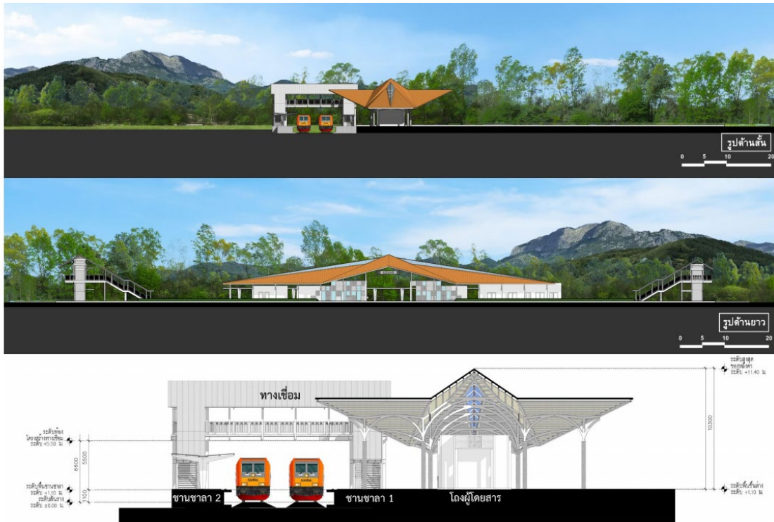
รูปที่ 3.10-11 รูปด้านและรูปตัด สถานีขนาดเล็ก
